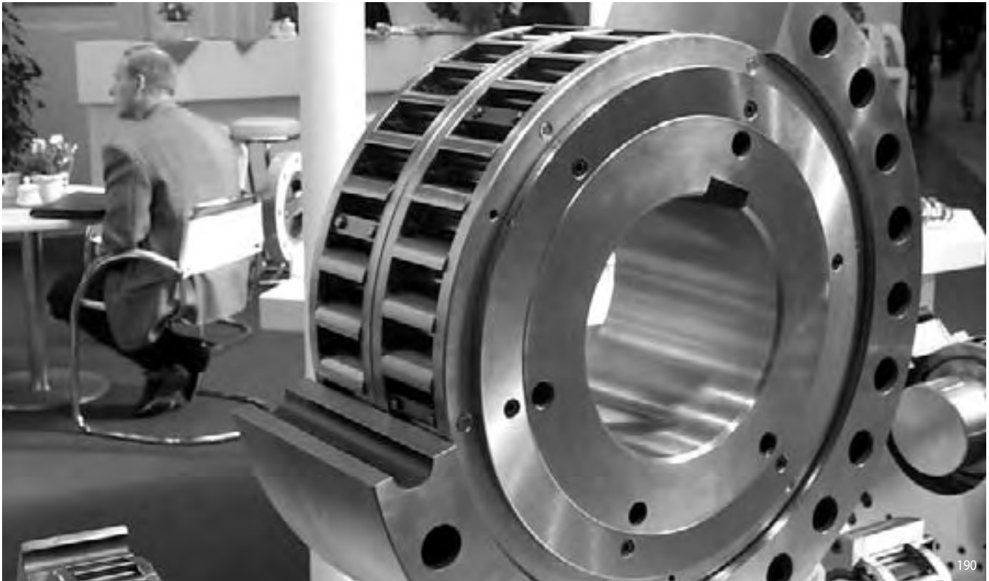
Antirretroceso FXM 2.410 - 100 UX para la bomba primaria de agua de refrigeración en una central nuclear. Par necesario 500 000 Nm, 1\,485\text{ min}^{-1} , en servicio desde 1996. Fabricado y probado, y con documentación extensa de RINGSPANN GMBH, Bad Homburg.
