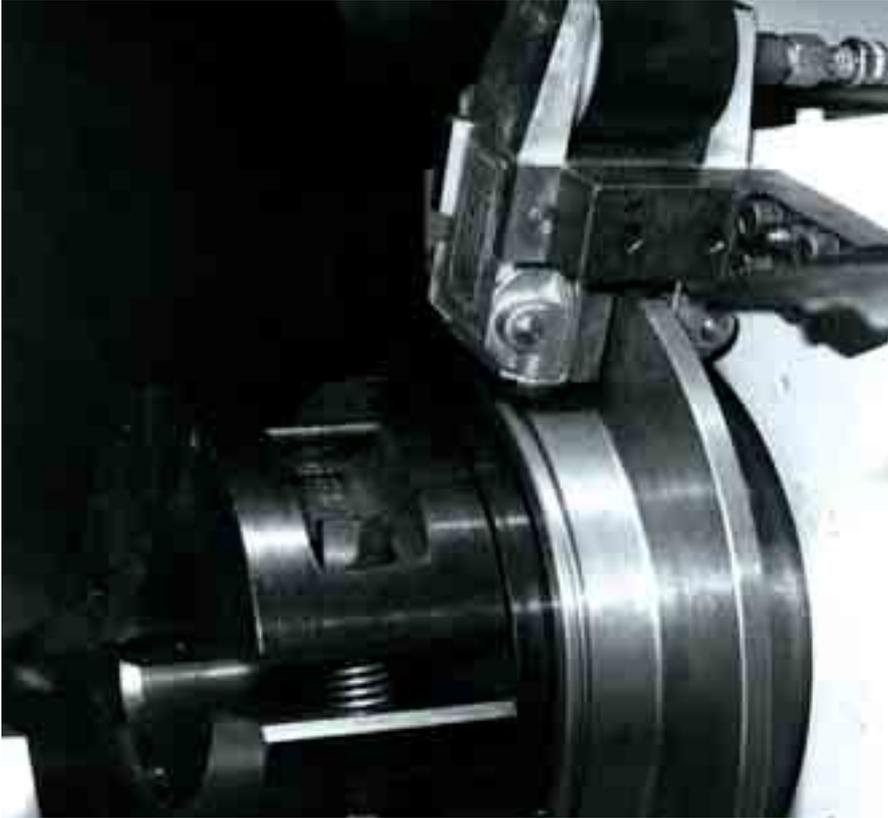
Pinza pneumatica tipo DH 15 P nel comando di una macchina da stampa a quattro colori. In ogni macchina da stampa viene montato un freno a disco tra il riduttore ed il cilindro stampa. Questo evita la rottura della carta durante una frenata di emergenza.
