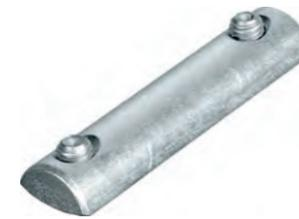
Los conectores de perfil conectan los perfiles laterales de dos transportadores dentro de una línea. Su forma especial garantiza la alineación de los perfiles laterales. Normalmente se necesitan cuatro conectores de perfil para conectar dos módulos de transporte entre sí.
