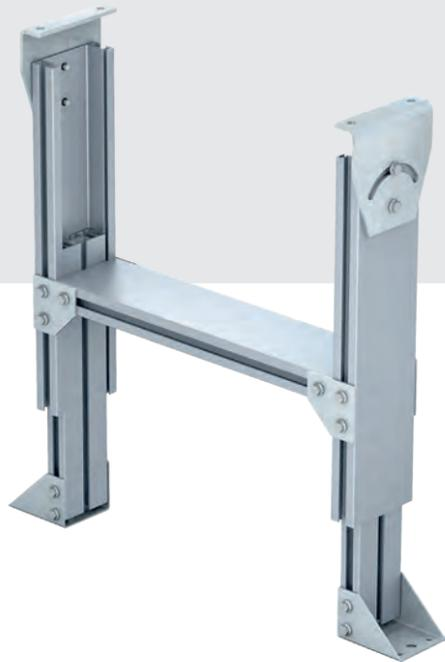
Los Interroll Support Stands RM 5704 constan de un resistente perfil de aluminio en el que se montan los módulos de transporte. Los soportes se fijan mediante un soporte angular en el bastidor lateral del transportador y, gracias a dos perfiles que entran uno en el otro, pueden ajustarse telescópicamente sin escalones dentro del rango de ajuste.
